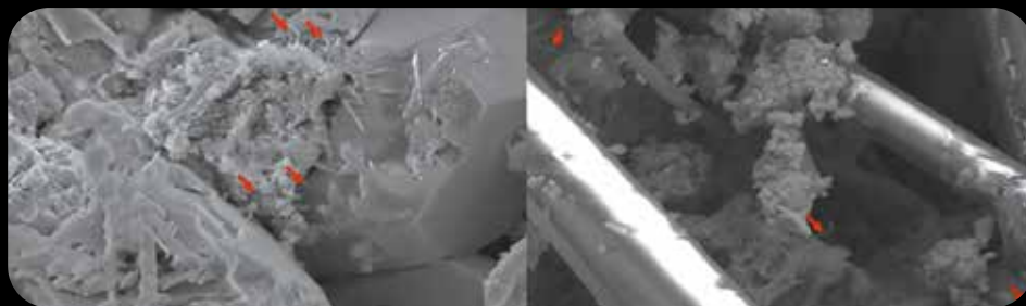
Полученное с помощью микроскопа изображение активного вещества пластины, прошедшей микроциклический тест на более чем 40 000 циклов. По прошествии теста структура нанотрубок сохраняется.
